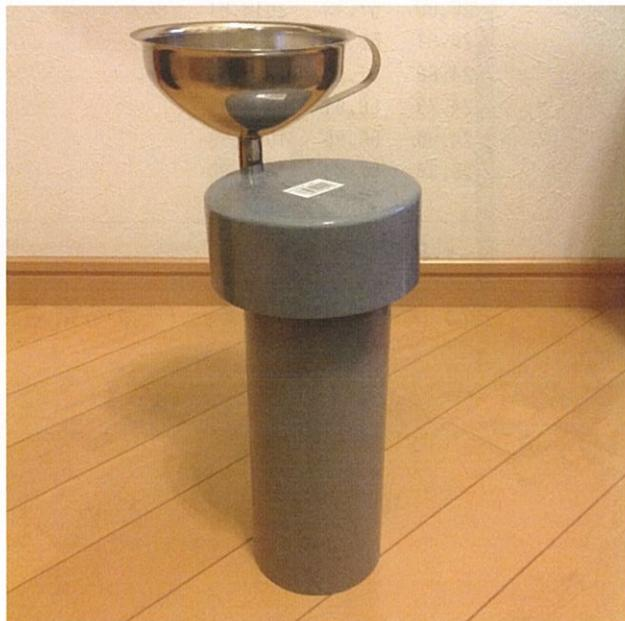
図4: 降雨の有無を判別するセンサーを付けたバージョン
