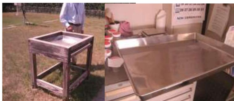
Fig.2 降灰量の装置とステンレス製のトレー（鹿児島気象台）
