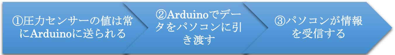
図 3 圧力センサーデータ転送プロセス
